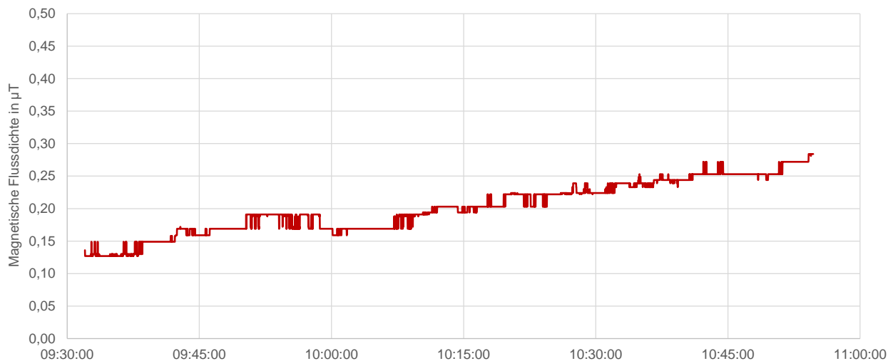
Abb. 9: Zeitlicher Verlauf der magnetischen Flussdichte am Referenzmesspunkt (Messpunkt B03) Der zeitliche Verlauf der magnetischen Flussdichte spiegelt den Lastverlauf des Umspannwerks mit höherer zeitlicher Auflösung wider (Abb. 9).
