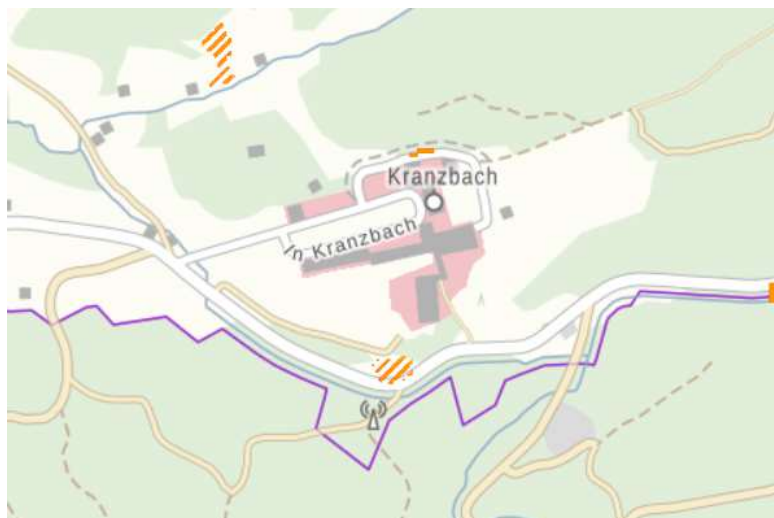
Abb. 8 orange schraffiert: Risikogebiete für Steinschlag und Rutschungen nördlich und südlich des Hotels (Quelle BayernAtlas Thema Naturgefahren, Stand 12.2023)
